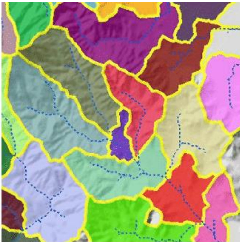
ภาพที่ 4 กลุ่มน้ำย่อยที่ถูกแบ่งโดยเครื่องมือ Watershed ใน โปรแกรม ArcGIS 10 ที่มา: ArcGIS 10 Help
