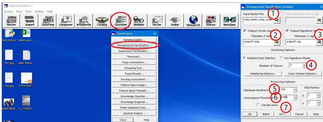
ภาพที่ 15 ขั้นตอนการตั้งค่าการจำแนกการใช้ที่ดินแบบไม่มีการกำกับ (Unsupervised classification) ด้วยวิธี ISODATA
