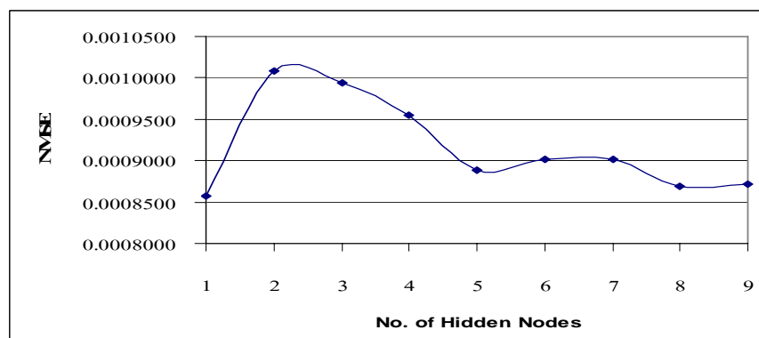
ภาพที่ 38 ความสัมพันธ์ระหว่างความคลาดเคลื่อนของแบบจำลองกับจำนวน Hidden Node ต่างๆ ของกลุ่มที่ 2
