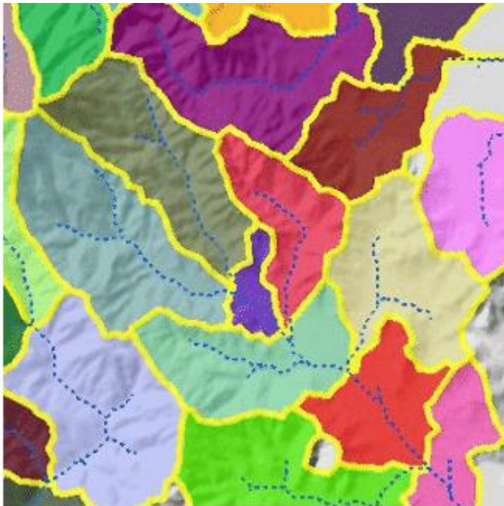
ภาพที่ 5 ลุ่มน้ำย่อยที่ถูกแบ่งโดยเครื่องมือ Watershed ในโปรแกรม ArcGIS 10
