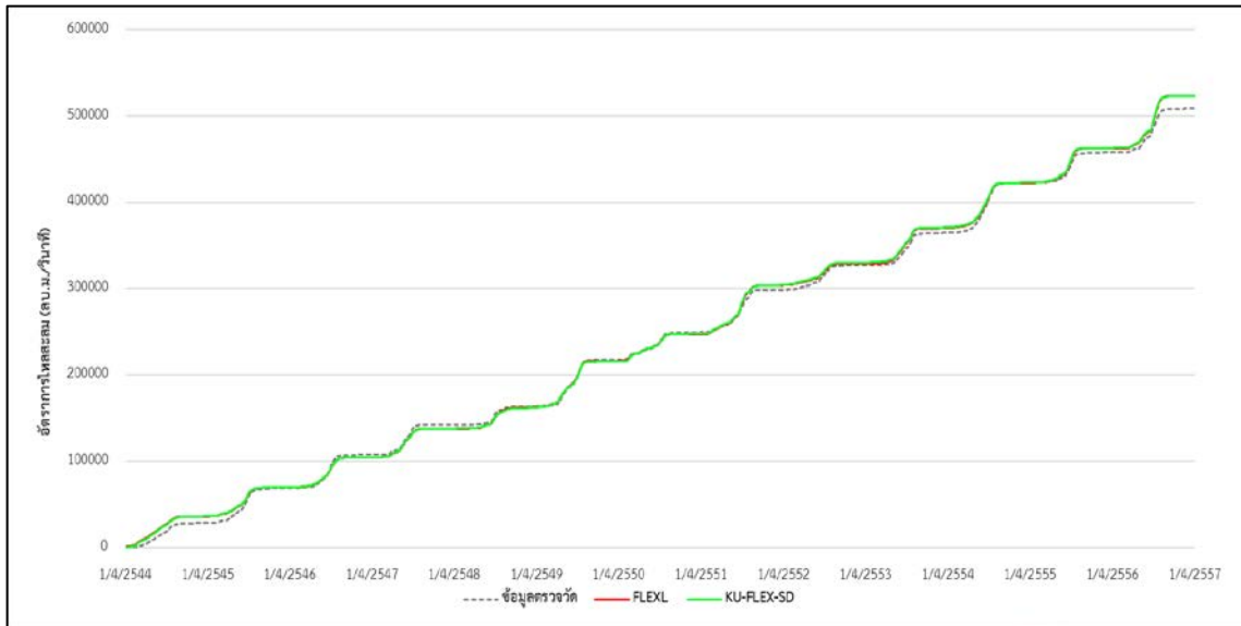
(ข) กราฟน้ำท่าสะสม (Mass Curve) ที่ได้จากแบบจำลองกับน้ำท่าสะสมที่ได้จากการตรวจวัด
